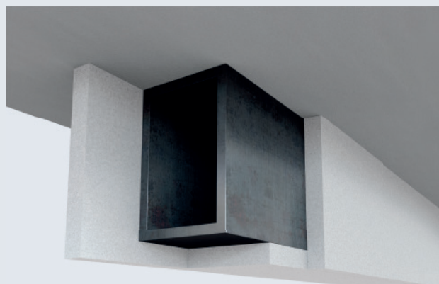
Dwarsbalk met gesloten profiel.
