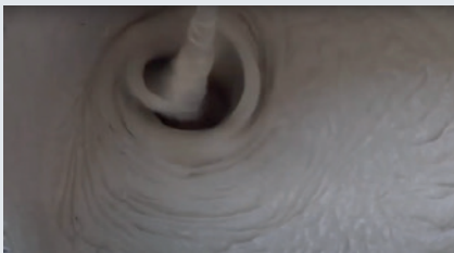
1 Amestecați tencuiala cu apă la proporția de amestecare specificată.
